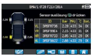
Anzeige aller Sensorinformationen für alle vier Reifen, einschließlich Sensor-ID, Druck, Frequenz, Temperatur und Batteriestatus.
