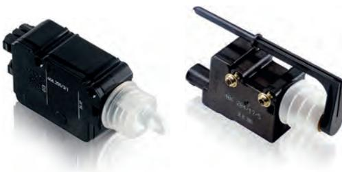
Stellelemente werden über die Zentralverriegelung bzw. über eine Fernbedienung angesteuert. Im Stellelement befindet sich ein Gleichstrommotor, der auf einen Stößel mit definiertem Antriebshub wirkt, welcher das Schloss öffnet und schließt. Bei manchen Modellen ist der Stößel in definierten Betriebszuständen zusätzlich mit einem Riegel zur Diebstahlsicherung blockiert.
