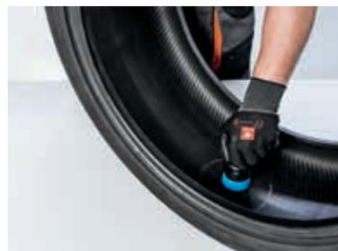
Der Gummicontainer mit dem VDO REDI-Sensor wird auf der inneren Reifenlauffläche verklebt.
