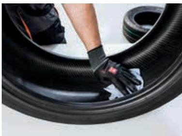
Die innere Reifenlauffläche wird vor dem Verkleben des VDO REDI-Sensors gereinigt.
