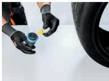
Der Kleber wird auf den Gummicontainer mit dem VDO REDI-Sensor aufgetragen.
