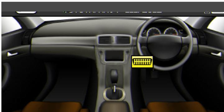
Connecter le module **OBD-II** sur le port **OBD-II** du véhicule, puis mettre le contact.
