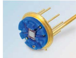
Das Funktionsprinzip der piezoresistiven Zelle beruht auf einem Silizium-Chip mit einer druckempfindlichen Membran. In dieser Membran befinden sich die Widerstände der Messbrücke. Über eine Edelstahlmembran erfolgt die Trennung zwischen dem empfindlichen Silizium-Chip und dem Prozessmedium. Zur internen Druckübertragung dient ein Silikonöl.
