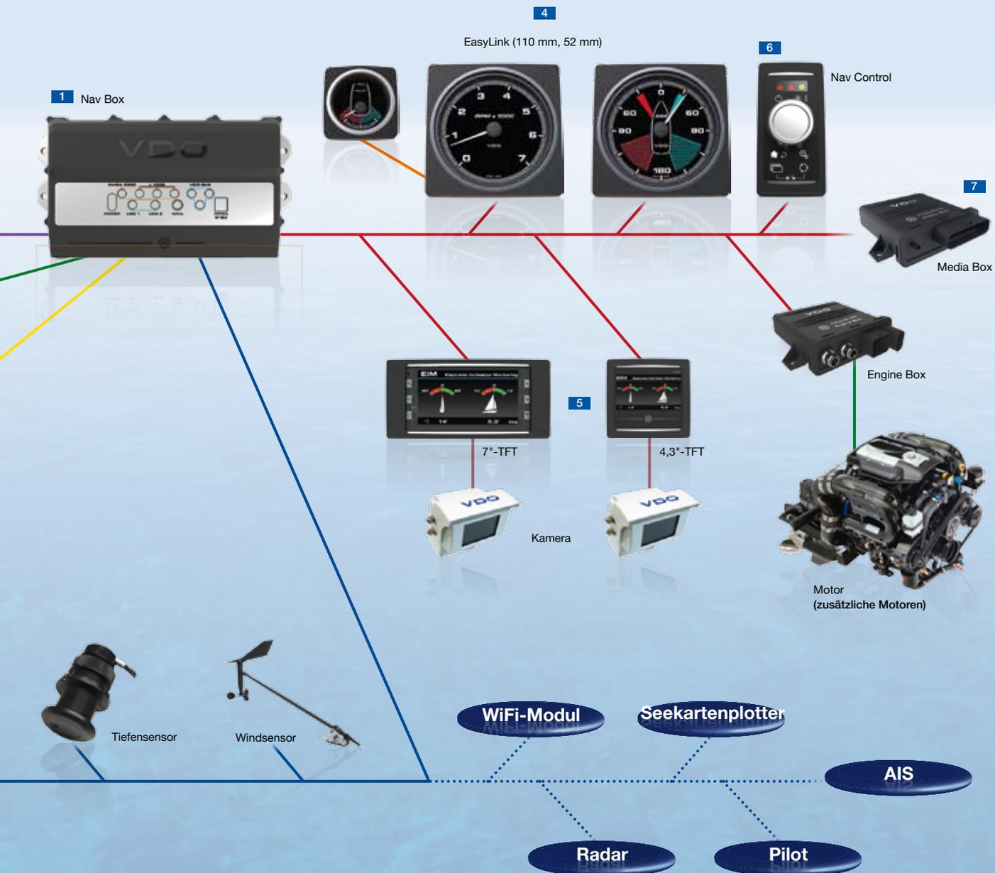
**6** Über das Remote Human Machine Interface werden mehrere strategisch platzierte TFT-Displays bedient. Damit ist der Zugriff auf nautische Informationen überall auf dem Boot möglich.
